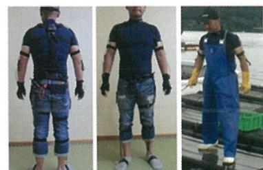
図2 作業動作計測のためのウェアラブルモーションキャプチャ
