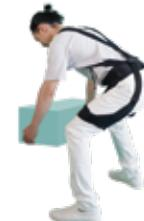
農業、介護、物流、建設など様々な作業において、作業員の腰痛予防を目指した、体幹の安定性を考慮したバッショブ型筋力補助装具です。補助力源として弾性素材を用いることにより小型・軽量化を実現しており、周囲に対する安全性が高く、腰を屈めた作業において、弾性力により腰回りの筋力を補助するとともに、同時にコルセットのような体幹安定効果を発揮することが特徴です。
