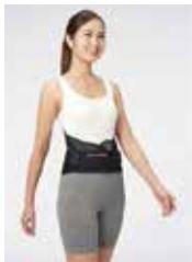
2015年に開発した着るだけで作業中の腰の負担を可視化することができる複数のセンサを内蔵したセンサ内蔵ウェアを更に進化させました。新たに背中の筋肉の活動を計測するセンサを内蔵することで、持ち上げる荷物の重さが分からなくても、腰の負担の増減を詳しく知ることができます。センシング技術を開発しました。荷物持ち上げ実験で、姿勢センサだけを用いた従来手法よりも平均で約3~5割、腰の負担の計測精度を高めることに成功しました。筋力補助スーツなどのアシストツールによって、腰に補助を受けたときにも、腰負担の軽減度合いを可視化することができます。
