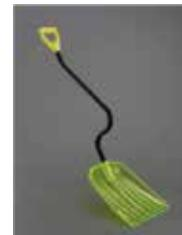
S字に曲がった柄部を特徴とする除雪用具です。持ち手の位置が高くなるため、雪をくう作業の時に、上半身の前屈角度が浅くなります。また、雪を乗せるバケット部が体に近い配置となるので、体の左右バランスを考えると、雪側に偏る荷重のアンバランスが改善されます。これらにより、腰部や背筋にかかる負担が軽減されます。畜舎作業など除雪以外の用途にも使われています。
